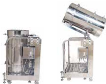
真横に設置した容器への移し替えが可能
